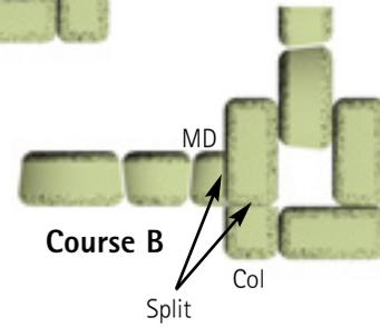
**PILASTER IN RUNNING WALL**
